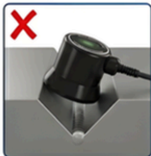
Incliné sur la surface
