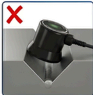
Incliné sur la surface
