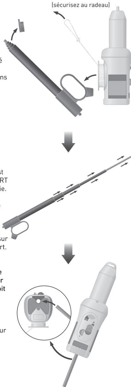
Montez le transpondeur radar SART à la verticale et sécurisez le mâtereau au radeau. La plupart des radeaux comprennent un dispositif de fixation prévu à cet effet.
